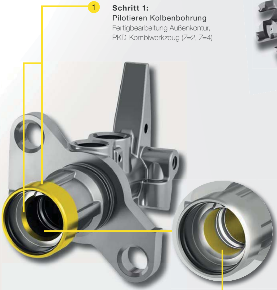
2 Schritt 2: Fertigbearbeitung Kolbenbohrung PKD-Reibahle (Z=6)
